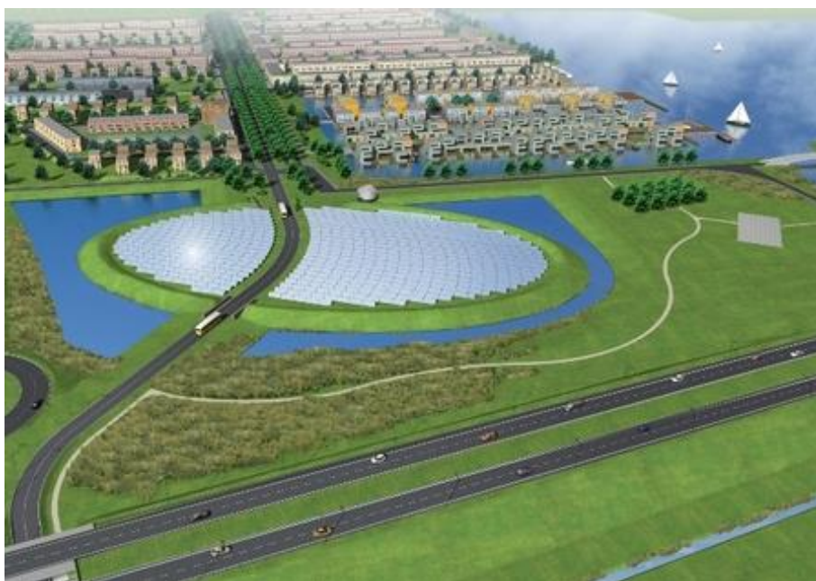
Figuur 20... Zonnewarmte eiland van Nuon in Almere, aangesloten op stadsverwarming 0,7 ha collectoroppervlak, 1,5 ha grondoppervlak. Productie 10 TJ per jaar
